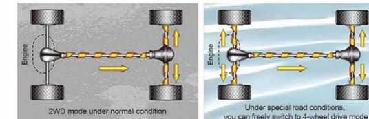
② Система повного приводу з електронним управлінням від Borg Warner
